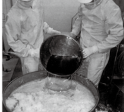
ダイスカットの玉ねぎを真空釜の原料と醸造酢と食塩を混ぜて煮け込む。玉ねぎに旨み付け、ぎゅぎゅとした食感に仕上げる。
